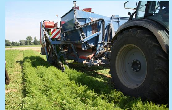
Die Maschine mit der die Möhren geerntet werden heißt Klemmbandroder.
